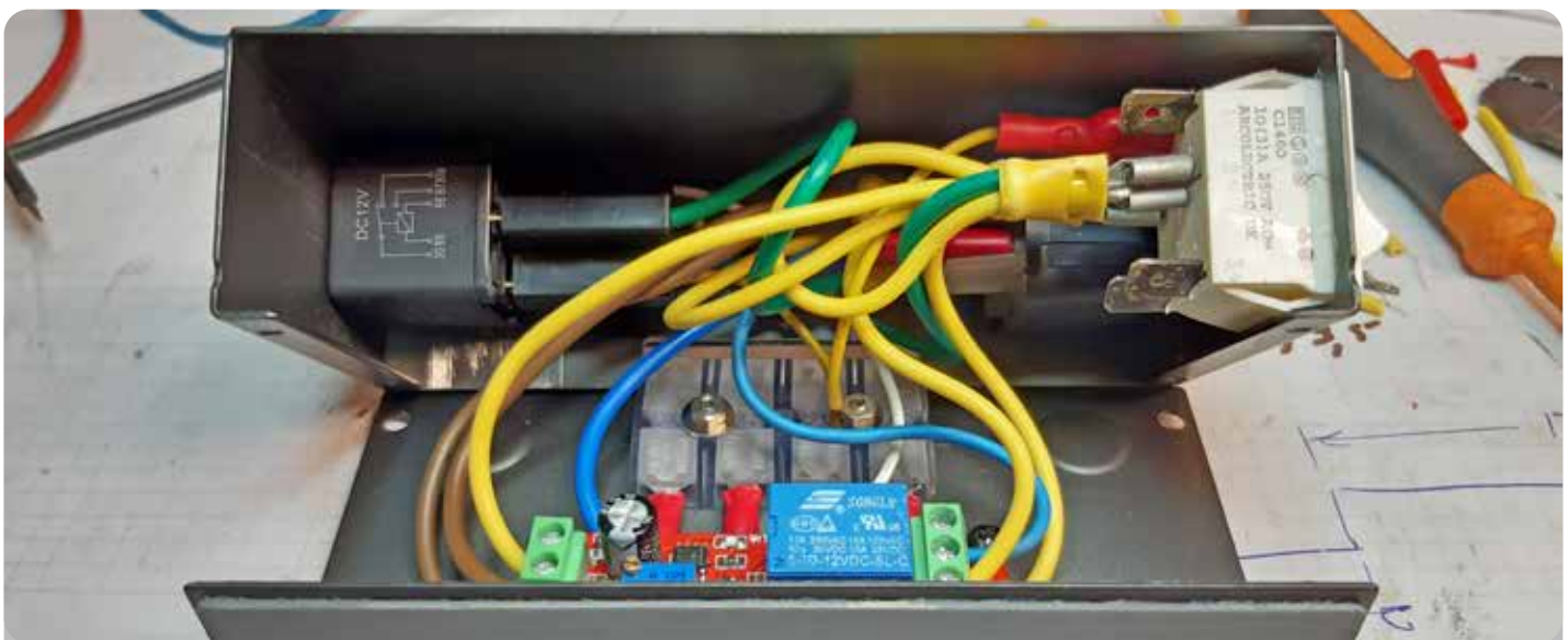
Inventaris oorspronkelijke 4-draads blackbox. Serviceswitch rechts.
