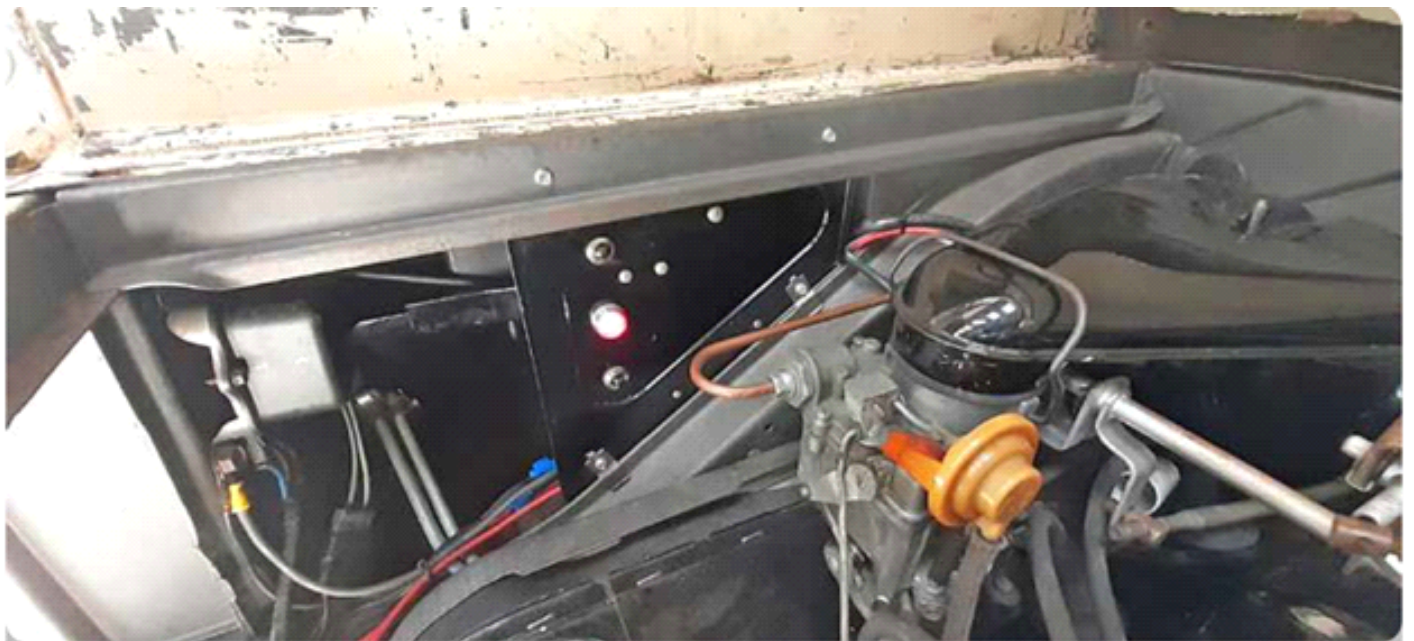
Contactschakelaar, olie/temp lamp en startdruknop
