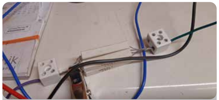
Voeding bobine via dummie weerstand
