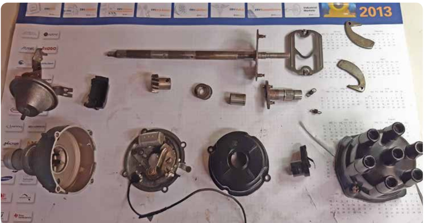
Verdeler gedemonteerd en alles gereinigd
